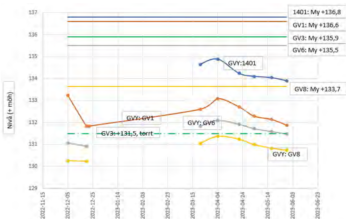
Figur 4: Redovisning av avlästa grundvattenytor i installerade grundvattenrör (C3S och Ramböll). Nivå markyta redovisas även i bild 2.
