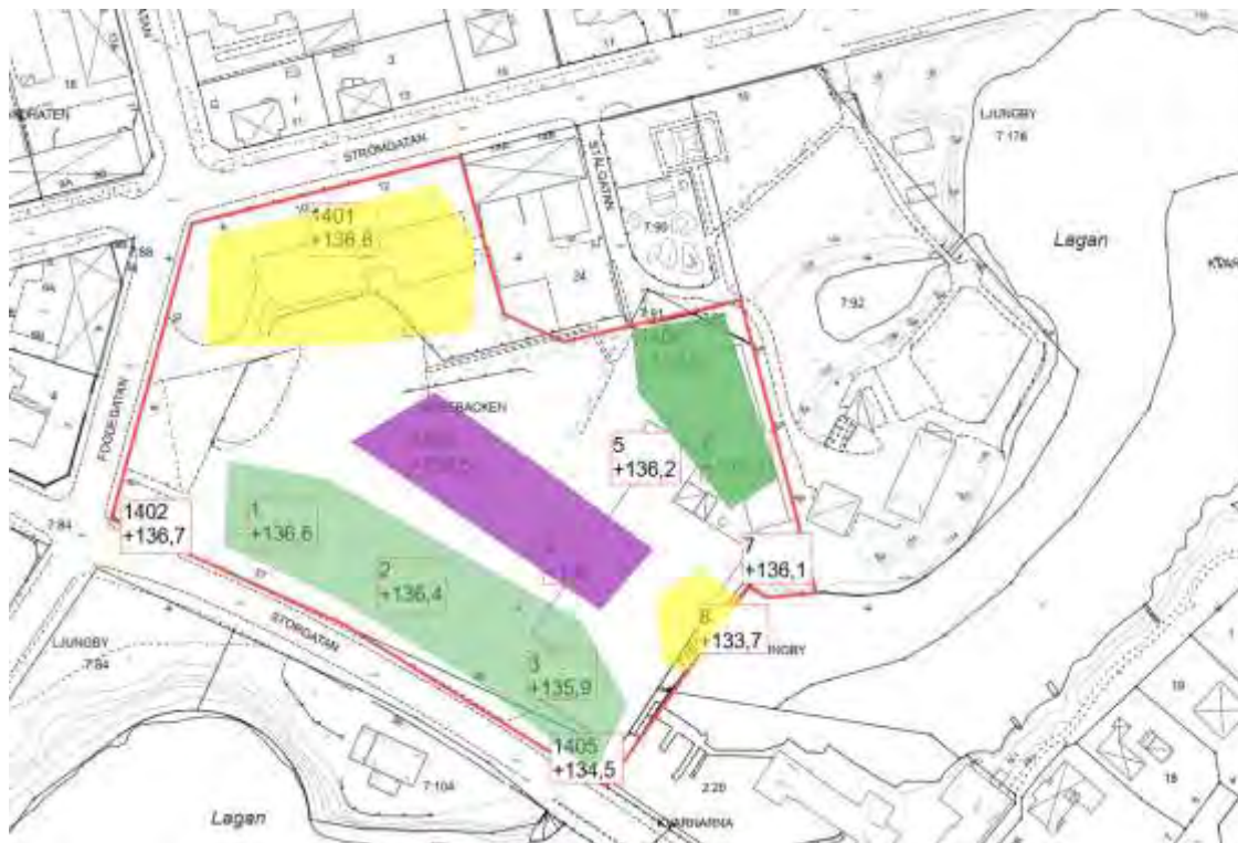
Figur 6: Grön: möjlighet till källargarage. Gul: möjlighet till källargarage med grundvattensänkning. Lila: inga grundvattenrör installerade.
