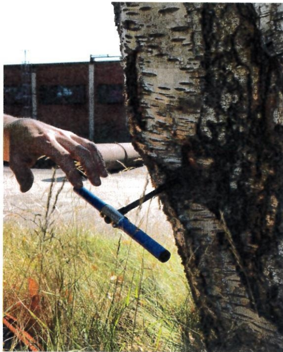
Figur 13. Provtagning med tillväxtborr av björk inne på Aspebacken 25; provpunkt CWM17.
