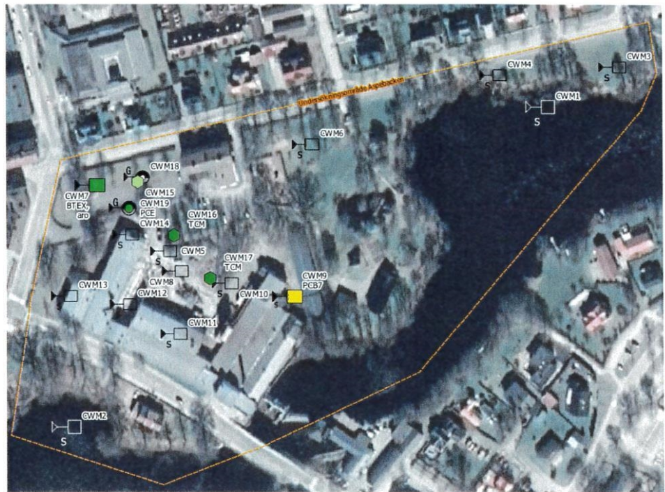
Figur 16: Aspebacken 25 översiktsskarta med översiktligt analysresultat avseende samtliga parametrar, förutom metaller, tagna på jord, sediment, porgas eller träd; gul = halt > KM, mörkgrön = detekterbar halt < KM och/eller annat riktvärde. Detekterad parameter under respektive provpunktsetikett. Detekterbara metallhalter återfanns i samtliga jord- och sedimentprover men underskred jämförvärde för KM och är därför inte markerade på bilden ovan.
