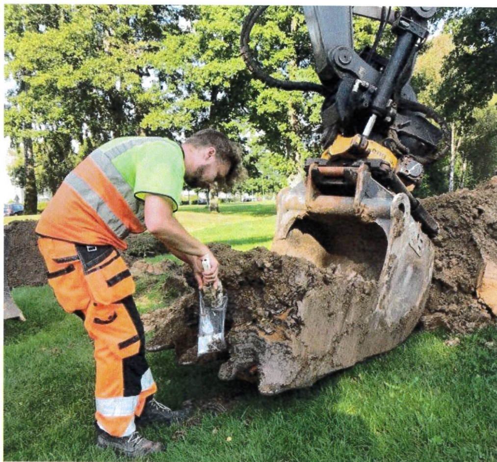
Figur 14. Provgropsgrävning i punkt CWM3, exempel på naturliga siltiga lager i undersökningsområdet.
