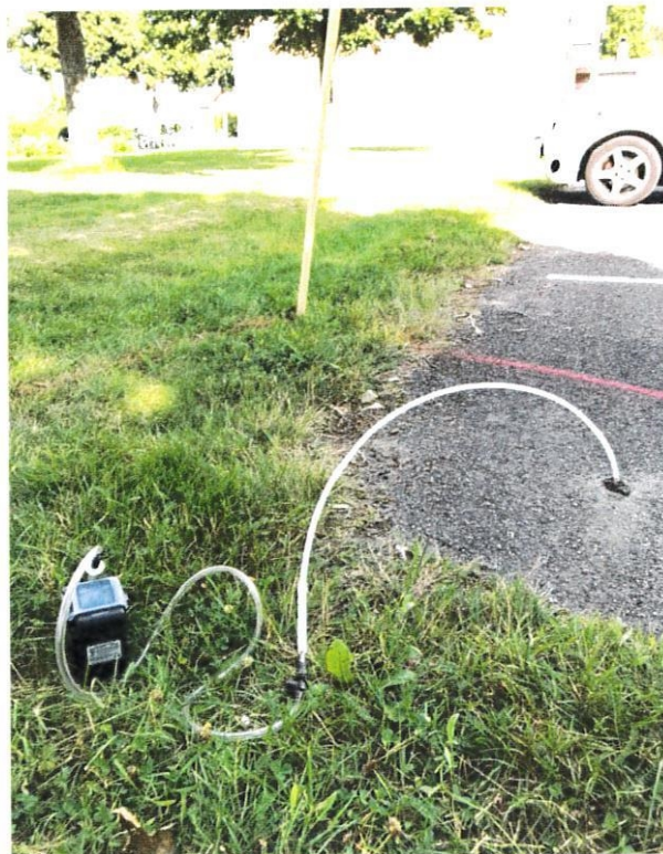
Figur 12. Porgasprovtagning med lågflödespump i punkt CWM18.
