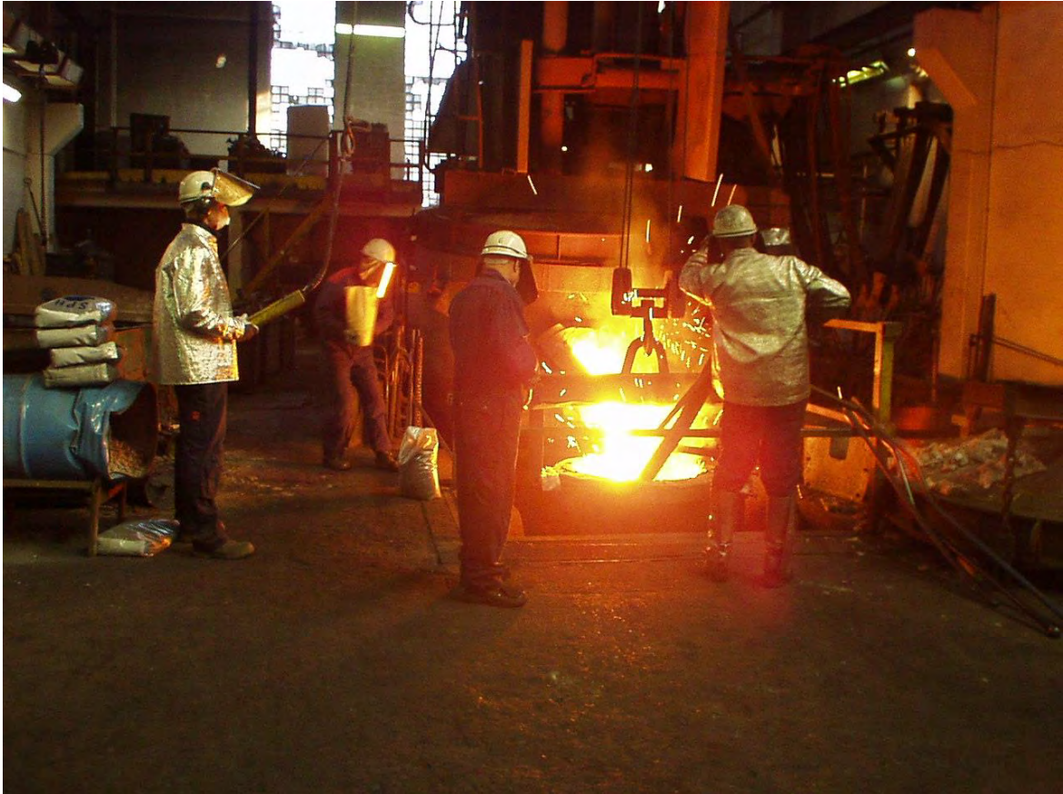
Avtappning av smält stål från ljusbågsugnen. I bakgrunden syns de höga glasbetongfönstren samt lastkajen. Foto via Bernt Lindeborg
