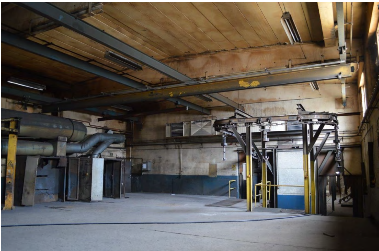
1962 års skepp utmed Storgatan. Här krokas godset av för behandling i arbetsbås där restprodukter skärs bort och produkten putsas ren. Notera vägg- och takkonstruktionens betongelement.
