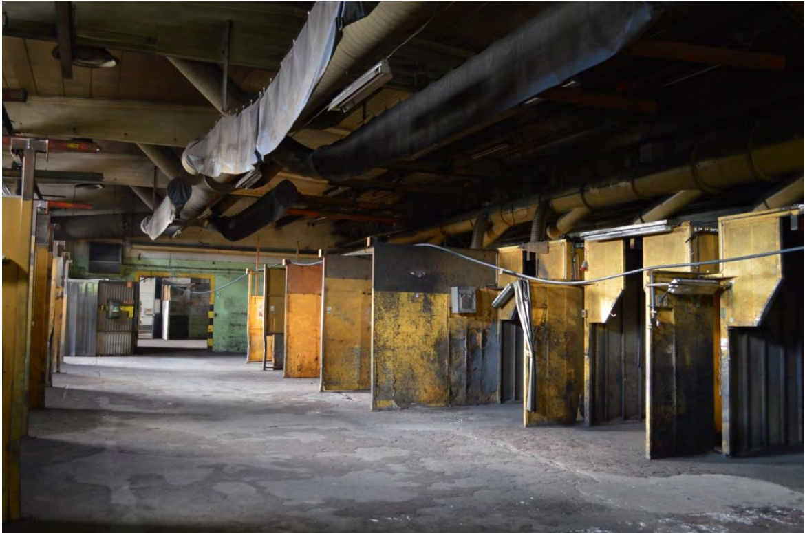
Några av alla de arbetsbåsar där gjutgodset rensades och slipades till färdig produkt.
