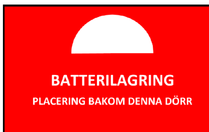
Figur 4. Exempel på skyltning av batterilager (Räddningstjänsten Storgöteborg, 2019).
